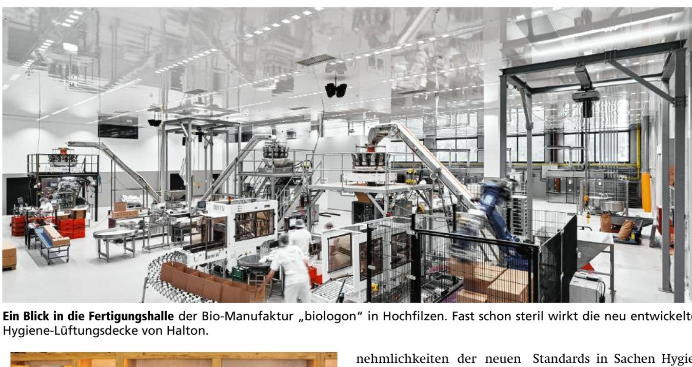
Ein Blick in die Fertigungshalle der Bio-Manufaktur „biologon“ in Hochfilzen. Fast schon steril wirkt die neu entwickelte Hygiene-Lüftungsdecke von Halton.
